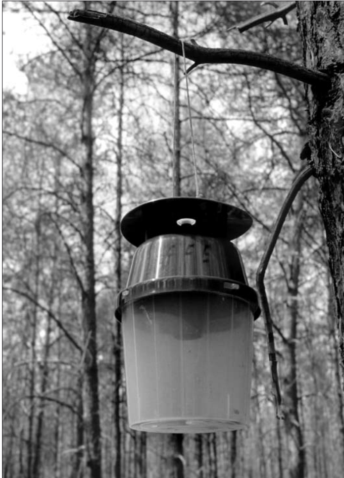
Abbildung 3: Lockstoffbestückte Variotrap zum Fang männlicher Nonnenfalter
